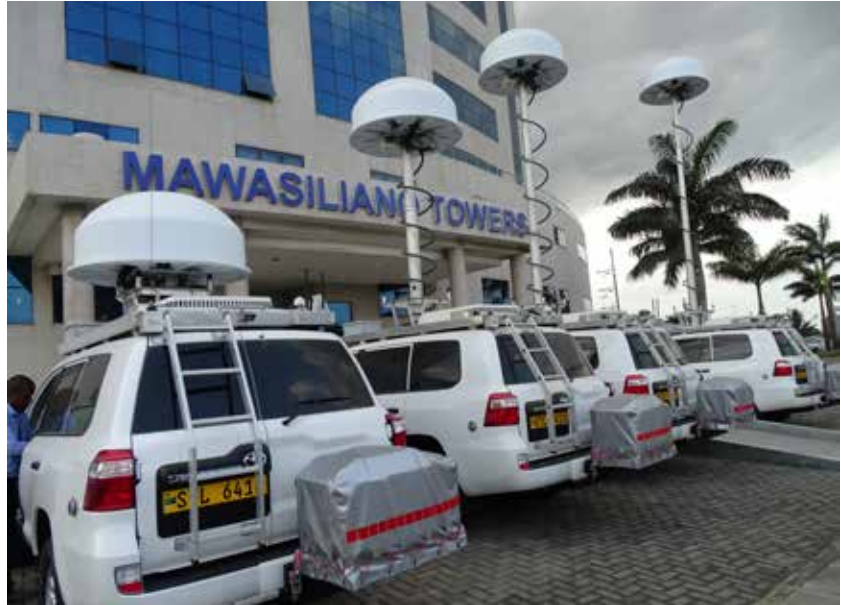
Magari yenye mitambo ya kufuatilia matumizi na mwenendo wa masafa; nyenzo muhimu kwa ajili ya usimamizi wa masafa ya kieletroniki nchini.
